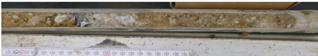
Bild 5: Verwitterungslehm mit Kalksteingeröllschutt mit Lehmanteilen (RKS 3)
