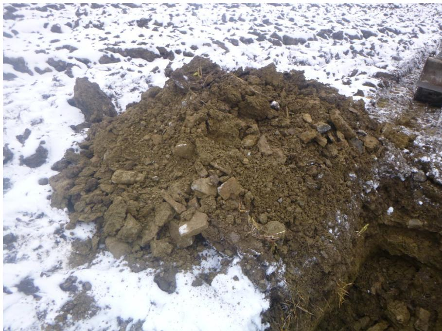
Bild 6: Verwitterungsschutt aus Kalkstein mit Lehmantteilen (SCH 1)
