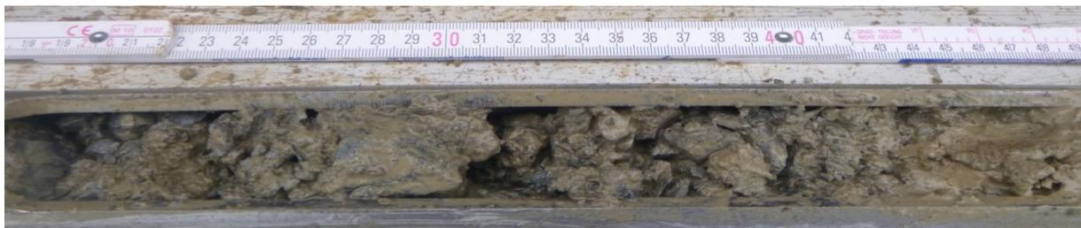
Bild 4: Tragschicht aus Kalksteinschotter und Sand, RKS 4
