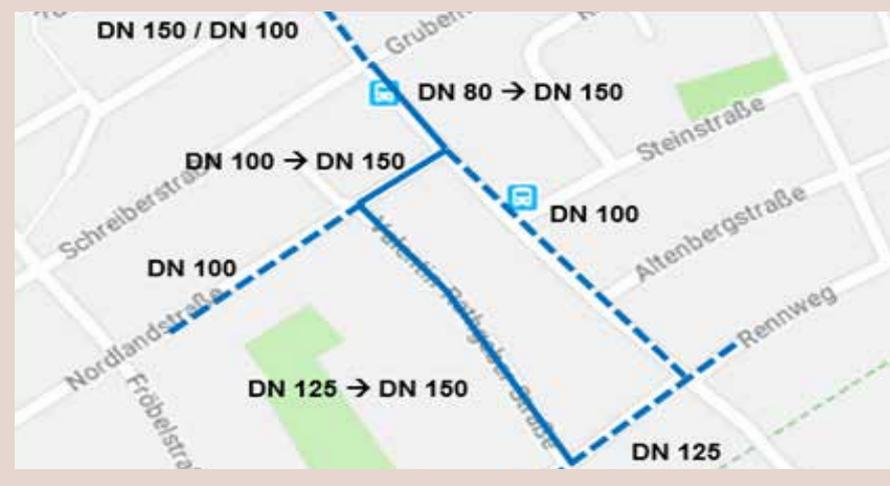
Die Trinkwasserleitungen in der Bündstraße, Nordlandstraße und Valentin-Rathgeber-Straße sind zum Teil erneuerungsbedürftig und zur sicheren Versorgung des Ortsnetzes Brendlorenzen in der Dimensionierung anzupassen. Aus diesem Grund werden die Trinkwasserleitungen in folgenden Teilabschnitten erneuert:
